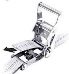
3. Losende in den Schlitz der Wickelwelle einfädeln und durchziehen, bis der Gurt gespannt ist. Das flache Gehäuse der Ratsche zeigt zur Ladung.
